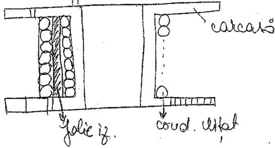
În peretii lat. se dau găuri și se scot capetele bobinajului dacă sârma e suf. de groasă (0,3 ÷ 0,5 mm), capătul poate fi cos direct, dacă e mai subțire ea nu rezistă la efort mecanic și se face o ancurare a terminalului și se lipesc în interior la un conduct. izolat de sect. mare și flexibil. În fct. de calitate izol. cond. se aducute și-n fct. de grosimea lui o armură între 2 spire alăturate se real. izol. uniform a stratului.
