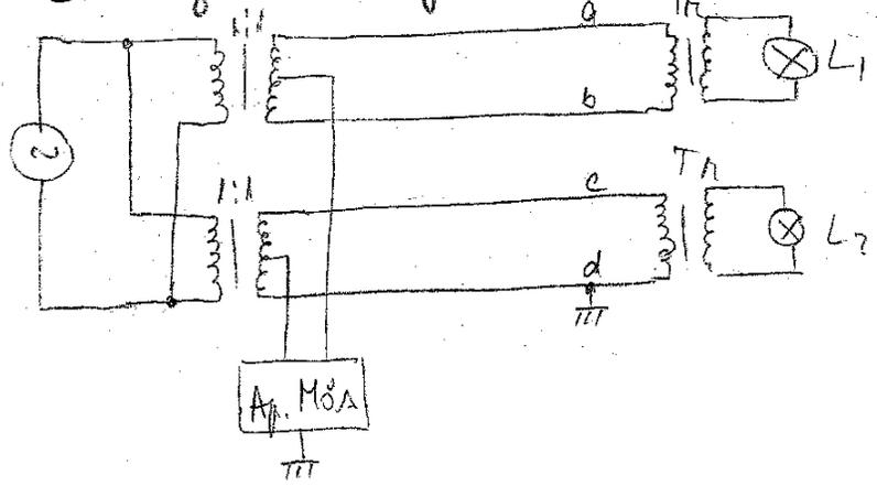
În instal. de HG. în toate cablurile se prevede în cond. supliment. de rezervă care permit scurta la pământ și de intervenție și reparație. Instal. prin izolarea imediată și erodării defecte și trecerea pe rezervă a funcționării alt. Sist. eronate pentru un artificiu și rezizarea cu sarcină aprox. locului în care se prod. degradarea iz. (+) cablu modern are cel puțin 2 nivel de iz. — al conduct. propriu-zis al mantalei de protecție
